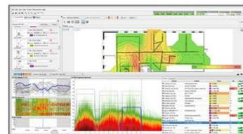
アクセスポイント設置後に無線状態を確認します。ヒートマップをご提示するほか、実際にWi-Fiを使用した際の通信速度も確認できます。
