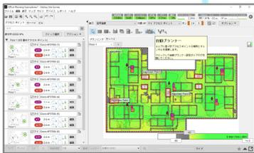
建物の図面（CAD、PDF）を読み込み、壁、パーティション、フロア高さなどの情報と、利用予定のAP種別から、最適なアクセスポイントの設置場所を割り出し、図面をご提供します。
